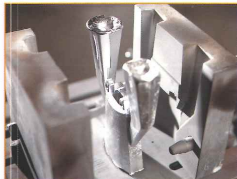
Fundición en coquilla. Chill casting.
