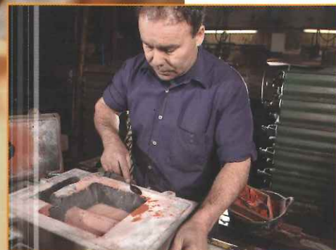
Moldeo en arena manual. Sand hand moulding.
