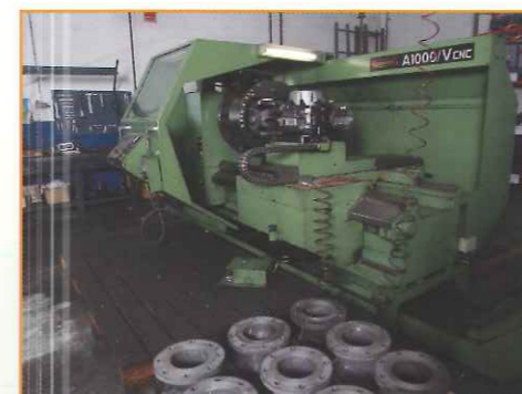
Torno de control numérico CNC con plato automático de Ø 800 mm. con giros a 90°. CNC numeric control lathe with automatic Ø 800 mm. plate and 90° turns.
